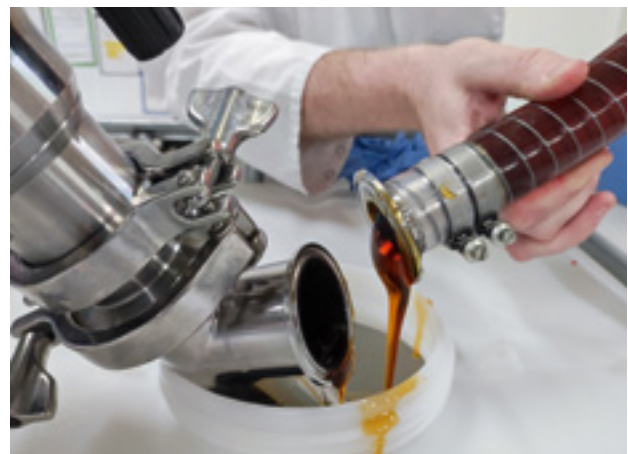
Fördern von viskosem Zuckerrohrsirup in einer Keksfabrik mit der Exzentrerschneckenpumpe VISCOPOWER F 580.
