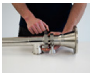
Clamp am Pumpenrohr öffnen
