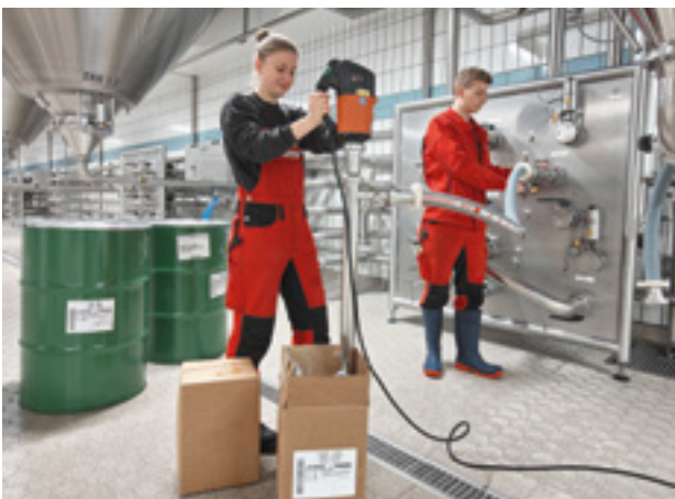
VISCOPOWER F 570 zum Fördern von viskosem Saftkonzentrat.
