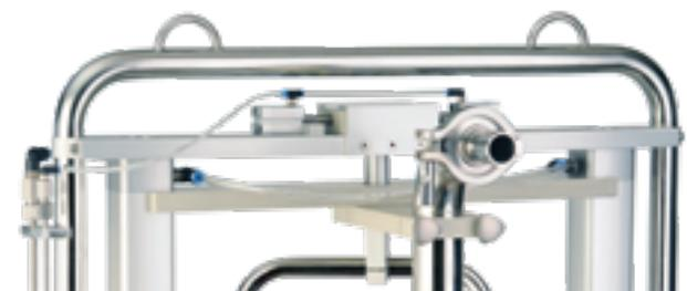
Transportvorrichtung mit zwei Ösen und pneumatischer Transportverriegelung.
