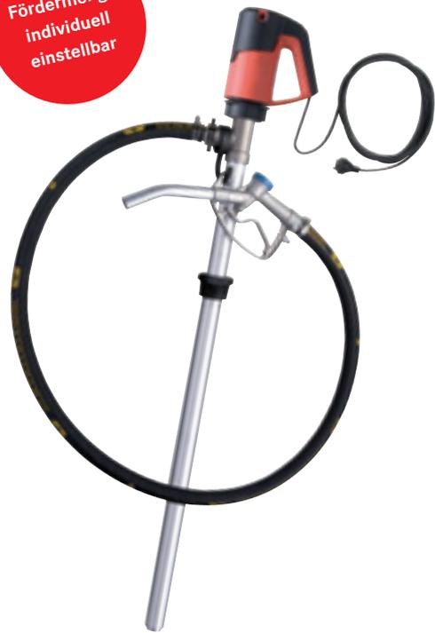
Beim Einsatz der Pumpe mit Schlauch und Zapfpistole beträgt der Förderstrom bei höchster Drehzahl max. 65 l/min.\*, Viskosität max. 600 mPas, Temperatur max. 80 °C, Förderhöhe max. 9,5 mWs.
