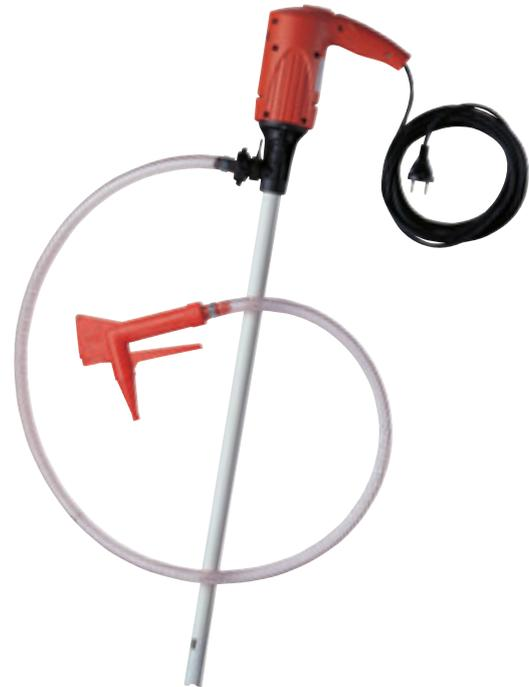
Beim Einsatz der Pumpe mit Schlauch und Zapfpistole beträgt der Förderstrom max. 16 l/min.\*, Viskosität max. 250 mPas, Temperatur max. 45 °C, Förderhöhe max. 5,5 mWs.
