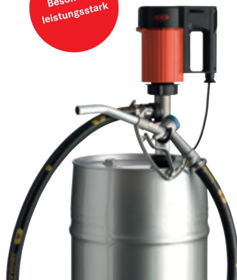
Beim Einsatz der Pumpe mit Schlauch und Zapfpistole beträgt der Förderstrom max. 80 l/min.\*, Viskosität max. 1.000 mPas, Temperatur max. 80 °C, Förderhöhe max. 12 mWs.
