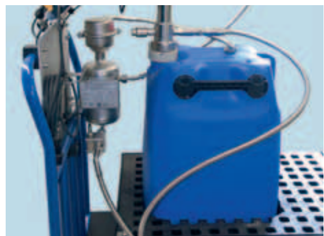
Hohe Dosiergenauigkeit auch bei der Erstabfüllung durch Kurzschlusspülmöglichkeit.
