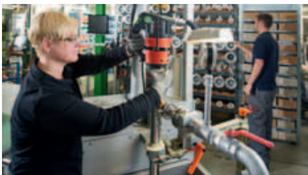
Jede Pumpe wird überprüft.
