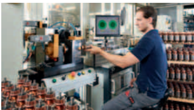
Ankerprüfung in der Wickelei.
