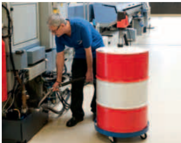
Befüllen einer Anlage mit Hydrauliköl (F 430 AL).
