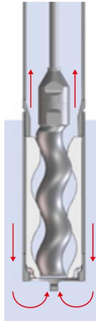
Ihr schneckenförmiger Rotor (Exzentrerschnecke) wird exzentrisch in einem als Gegenstück geformten Stator geführt. Dadurch entstehen bei der Drehung in sich geschlossene Hohlräume, in denen das Medium besonders schonend und pulsationsarm, kontinuierlich nach oben gefördert wird.
