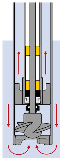
der Rotor vollständig mit Medium bedeckt sein. Durch die Rotation wird das Medium axial gefördert, d. h. parallel zur Pumpenwelle hin zum Druckstutzen.
